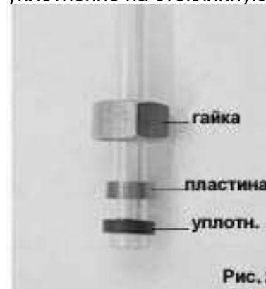
Вставьте трубу в соединение. Легким нажатием закрутите гайку зажимного соединения (рис. 4).
