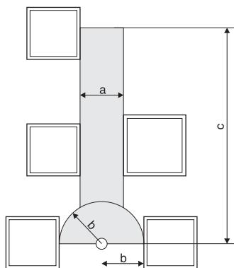
Якщо вісь виходу знаходитьсь на відстані  $d > 0,3$  м під верхньою частиною конструкції вікна, то створена зона не може потрапляти до простору, котрий утворює вікно. У випадку відстані  $d \leq 0,3$  м зона обмежена радіусом  $b$  потрапляти до верхньої частини вікна.
