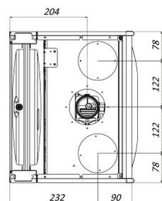
В которых забор воздуха и удаления продуктов сгорания осуществляется по двум различным трубам. Такие системы хорошо подходят для домов с поквартирным отоплением. С целью экономии средств и площади современные дома с поквартирной системой дымоудаления имеют всего одну шахту – дымоотводящую, а воздухозабор осуществляется с фасада здания.
