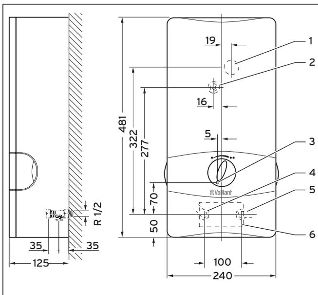
Рис. 5.2 Размеры аппарата
