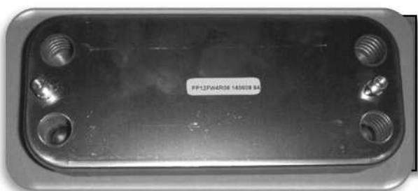
Установлен между правым и левым гидравлическими блоками посредством болтового соединения. При возникновении необходимости в горячей воде, обеспечивает нагревание воды поступающей из главного теплообменника и горячей воды. Теплообменник хоз.воды сделан из пластин из нержавеющей стали. Для максимальной теплопередачи, отопление и хоз.вода проходят в противоположных
