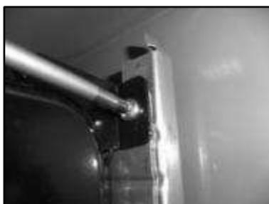
Рисунок-4 Снятие верхнего винта расширительного бака.
