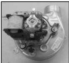
Расположен в верхней части камеры сгорания. Его функцией является обеспечение чистого воздуха в камеру сгорания путем вакуумирования во время выпуска отработанных газов. Благодаря строению вентури внутри вентилятора, реле низкого давления контролирует забит или открыт проход отходящих газов.
