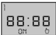
На рисунке сбоку показан экран когда программа настройки времени находится в ручном режиме то есть прибор работает независимо от программы настройки времени. В таком режиме в вместе с надписью "ON" в нижней части экрана показан рисунок руки. Программа настройки времени в ручном режиме работает независимо от программы прибора.
