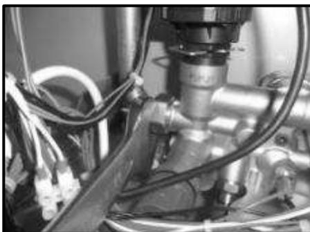
*Рисунок-11 Снятие уходящей отопительной трубы с помощью гаечного ключа.*
