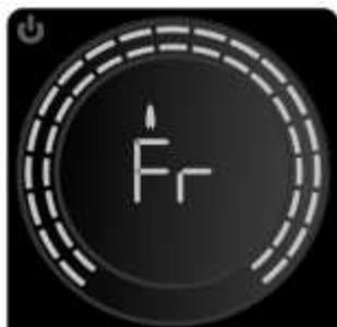
При активизации защиты от обледенения в котлах A Integrity Plus / Instant model на светодиодном экране используемой воды появится надпись "Fr". Затем появится показатель температуры воды
