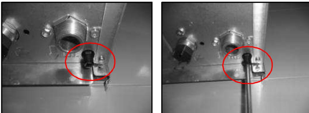
Рисунок-1 Сливная пробка
