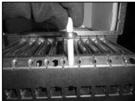
*Рисунок-8 Снятие электрода зажигания.*
