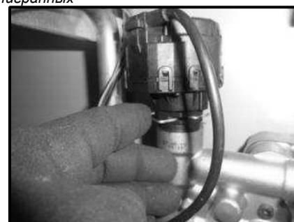
Рисунок-7 Закрепление трёхлинейного распределителя с помощью клипса.
