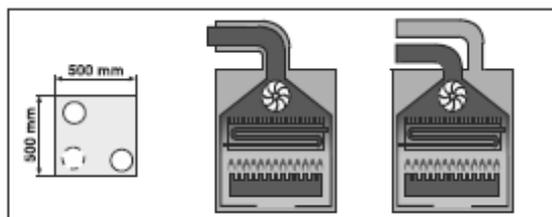
**C32:** Используя вертикальный дымоход, труб дымохода коаксальных линий сгорания воздуха, или 2 параллельные трубы для прямого подсоединения в атмосферу (котлы с определенным газом). Между трубой сгорающего воздуха и дымового газопровода должно быть расстояние минимум 250 мм.и последние детали обеих труб должны находится в квадрате в 500 мм.
