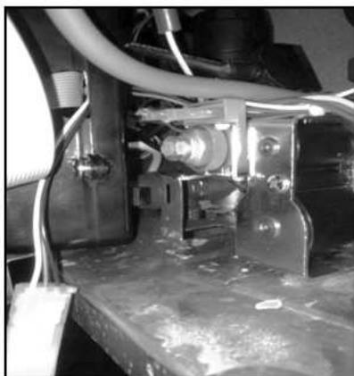
*Рисунок-4 Пластмассовый зацеп отделён от металлической пластины.*
