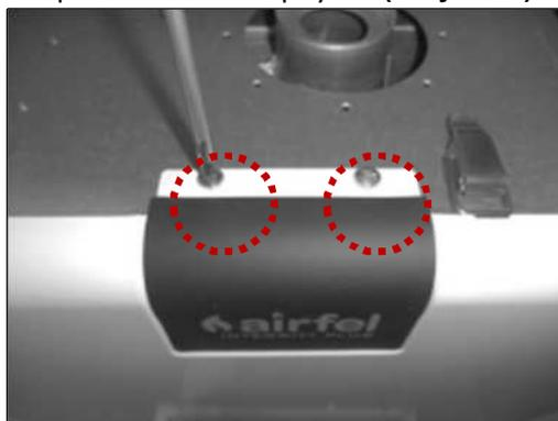
Рисунок-1 Снятие винтов с верхней части передней крышки
