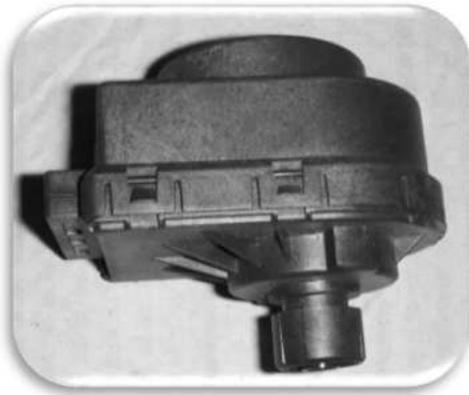
Двигатель с 230 В питанием. Установлен на линии подачи отопительного контура, на левом гидравлическом блоке. Двигатель трехходового клапана, при возникновении потребности в хоз.воде направляет воду из отопительного контура выходящую из главного теплообменника в теплообменник хоз.воды.
