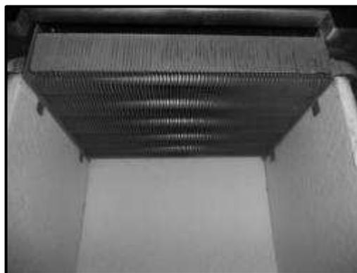
*Рисунок-12 Установка главного теплообменника в камеру горения.*
