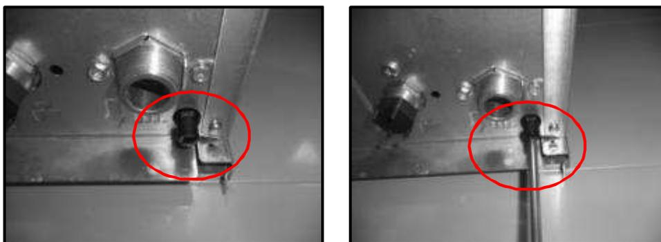
Рисунок-1 Сливная пробка
