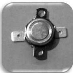
Установлен сверху трубы выхода системы отопления главного теплообменника. Защищает котел и систему от негативных ситуаций возникших вследствие чрезмерного нагрева воды. На выходе главного теплообменника, при достижении температуры воды 90 °C ( $\pm 4^{\circ}\text{C}$ ) лимит.термостат выключает котел. После того как вода охладится до 80 °C  $\pm 12^{\circ}\text{C}$  котел возобновляет свою работу.
