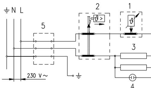
Схема электрического подключения
