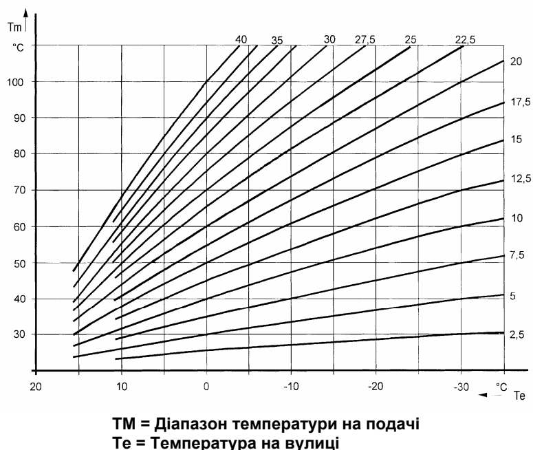
Рис. 11: Вибір робочої кривої датчика вуличної температури за наявності кліматичного регулятора QAA73
